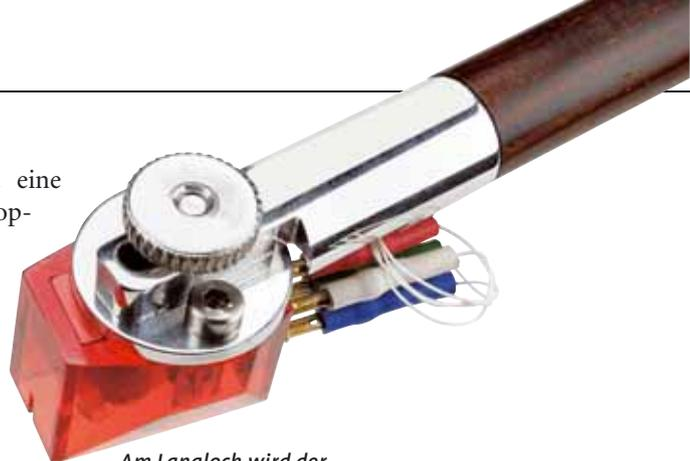
*Am Langloch wird der Überhang eingestellt, an der runden Scheibe die Kröpfung – die Rändelmutter ermöglicht eine schnelle und komfortable Fixierung*
