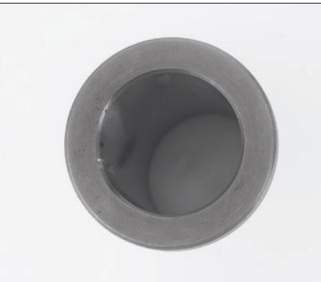
*Die Lagerbuchse hat einen Teflon-Spiegel für optimalen Leichtlauf und Langlebigkeit. Die Schmierung erfolgt praktischer Weise von oben durch eine Bohrung im Plattendorn*
